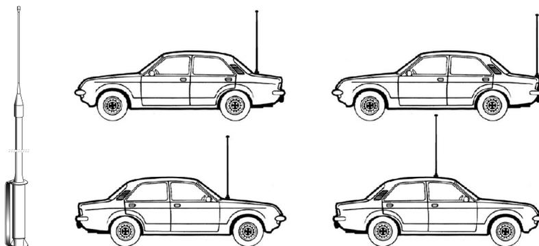
**Установка на крыше** – в этом положении антенна в равной степени излучает во всех направлениях. Однако в данном случае использование полноразмерной четвертьволновой антенны, как правило, проблематично.
